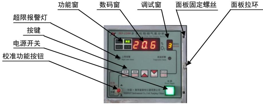
图 7 转换器的操作面板图
